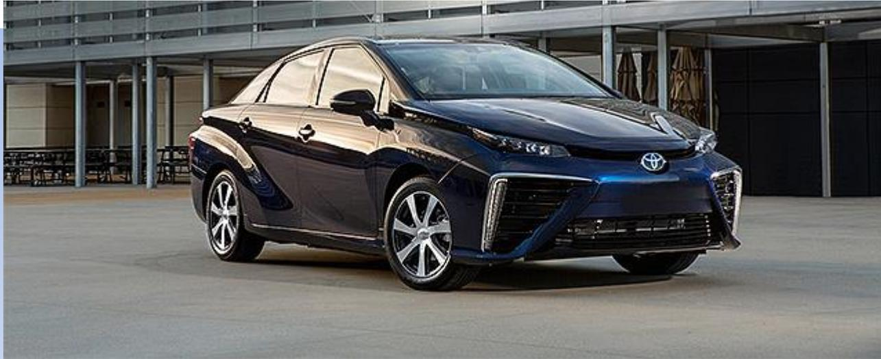
在氧氣及氫氣的作用下，氫燃料電池車款即可生成動能，而排放出來的只有水蒸氣。在充滿燃料的前提下，Mirai的巡航里程可達到約**500**公里，而燃料用罄時補滿的時間也僅需約**3**分鐘
