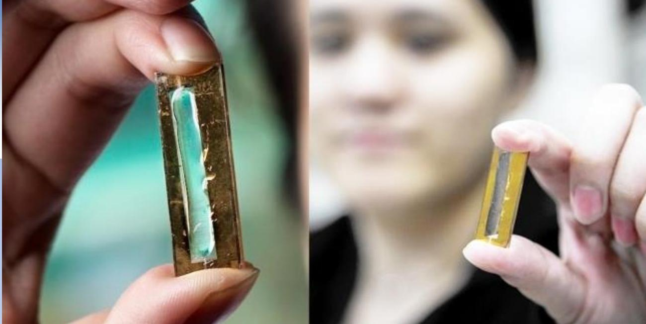
。 (圖左為 Mya Le Thai 博士) 帶領研究的 Mya Le Thai 博士表示，她是在實驗室玩樂時不小心發現永恆電池的。當時她在二氧化錳 (Manganese Dioxide) 上塗了金納米線 (Gold Nanowires)，然後再應用了「有機玻璃狀」的電解質凝膠。在正常情況下，納米線擁有極高的導電性，但由於它比人類的頭髮還要細幾千倍，導致它最多只有 8000 個充電週期的使用壽命。但研究人員發現，在 3 個月的實驗結束後，當時製作的電池仍完好無缺；因此，他們懷疑凝膠增塑了電池內的金屬氧化物，繼而大幅增加了電池的使用壽命。他們的發現可說是帶給了電子產業一個巨大衝擊，相信未來或會引起一場業界改革。然而，這種電池技術仍然處於研發階段，估計在成為商業化產品前依然有一段距離。
