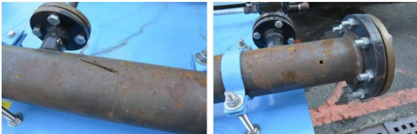
仿真模組車輛配置應變人員遭遇的各種洩漏情況的仿真設備，圖為模擬
