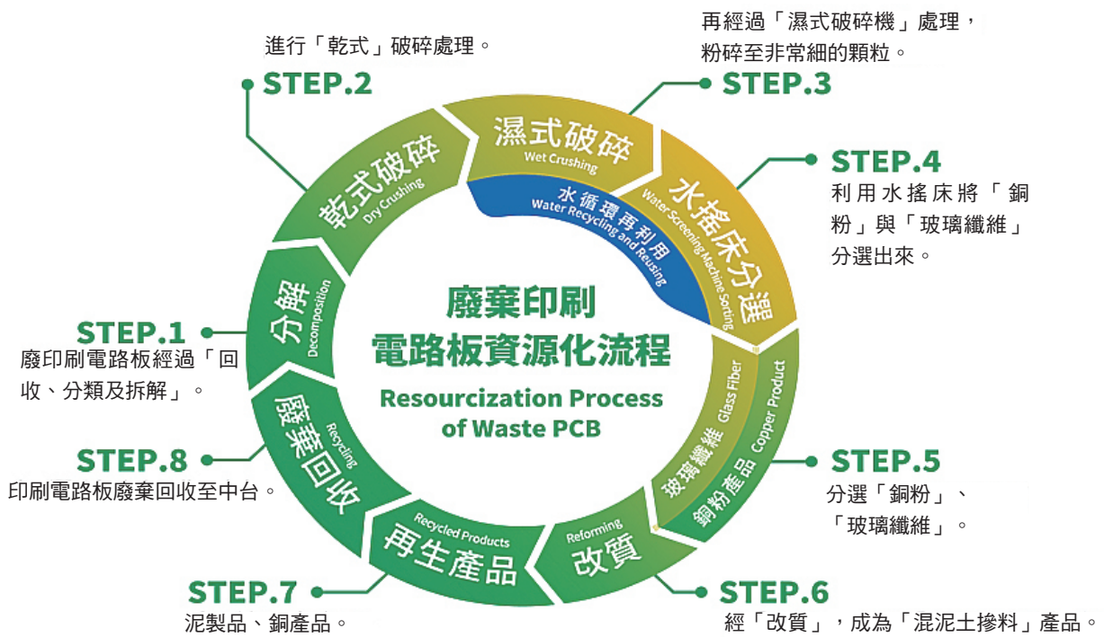
廢印刷電路板資源化處理步驟
