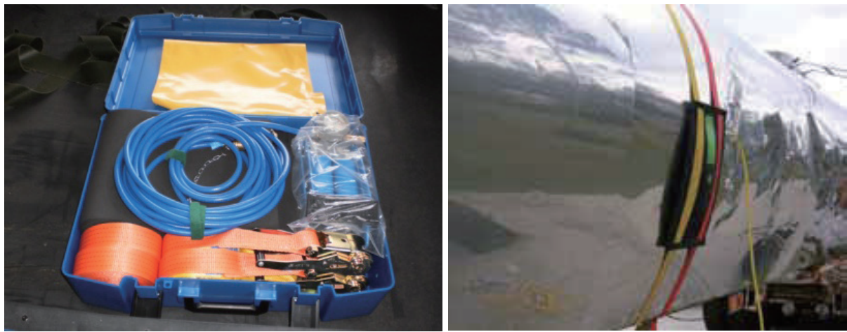
▲ SAVA槽車止洩片及使用於槽車示意圖
