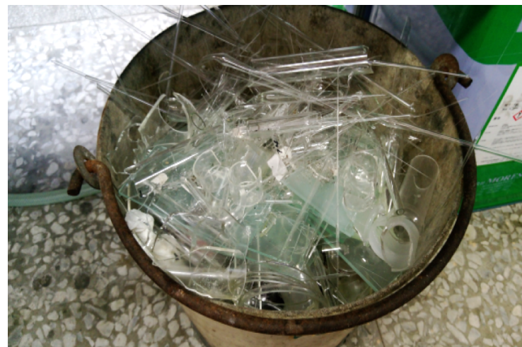
圖二十六 廢棄碎玻璃應先清理乾淨，收集在堅固而不易刺穿的載具中暫存，上圖的玻璃收集太滿，廢玻璃已突出桶外會有刺割傷風險。
