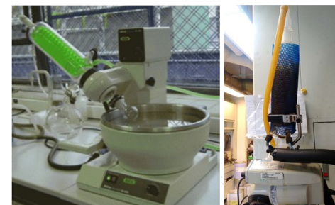
圖二十五 左邊迴旋濃縮器冷凝管並沒有防護網包覆
