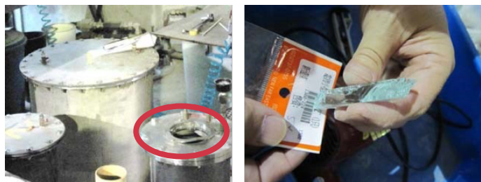
圖二十九 左邊為現場爆裂銅瓶；右邊為現場爆裂的觀測窗玻璃
