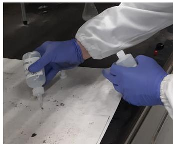
圖一 使用吸瓶吸除汞液滴。
