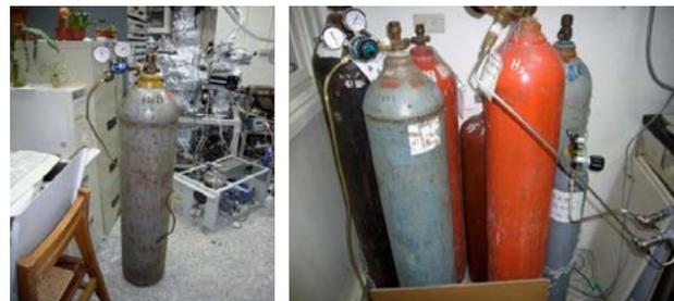
圖十六 常見的鋼瓶管理不當例子，鋼瓶未加固定、各類氣體（其中有氫氣，乙炔等高公共危險性氣體）混處、未與電器設備保持距離。
