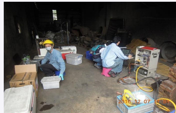
步執行排放管道戴奧辛檢測作業
