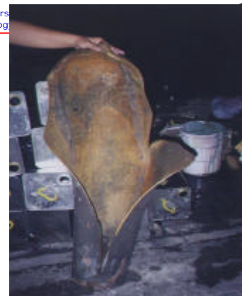
發生爆炸的環氧 乙烷鋼瓶外觀
