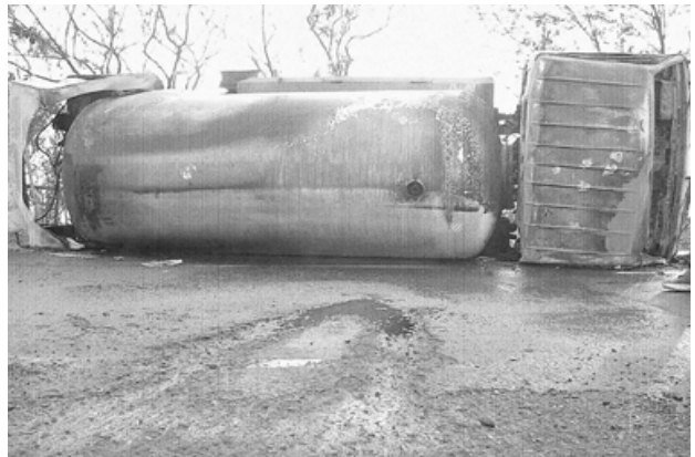
圖8 燃燒完之液化石油氣槽車
