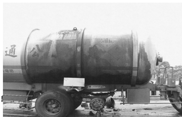
圖5 1,3-丁二烯槽車輪胎起火燃燒，槽體被煙燻後之情形
