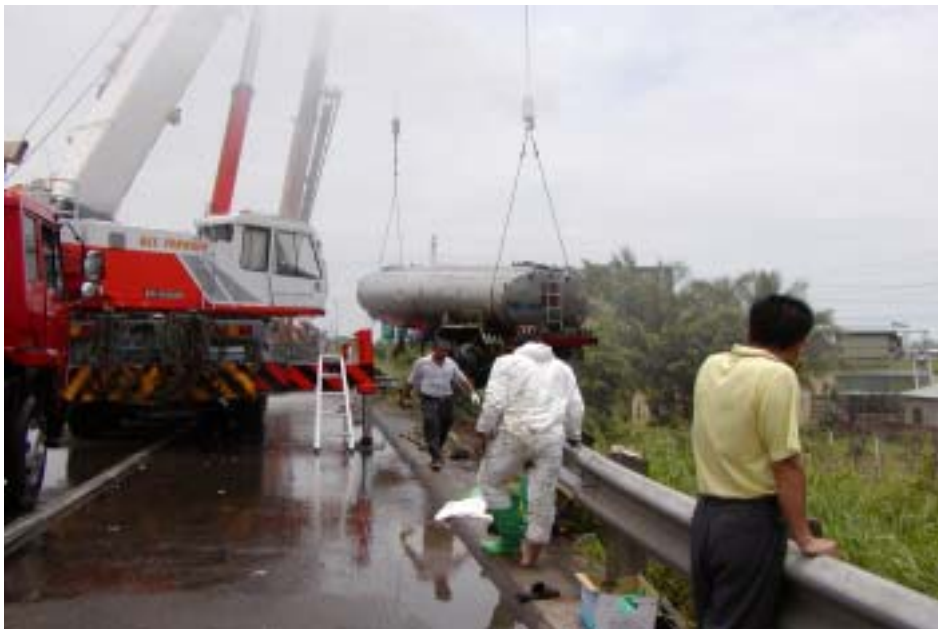
圖 3.9 將槽車以起重車及吊車吊起之情形
