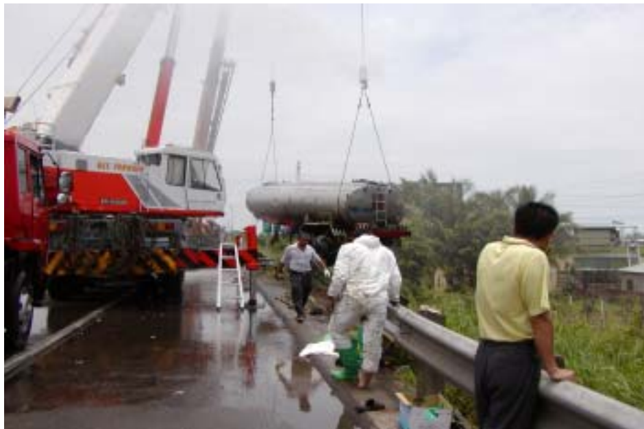
圖 3.9 將槽車以起重車及吊車吊起之情形
