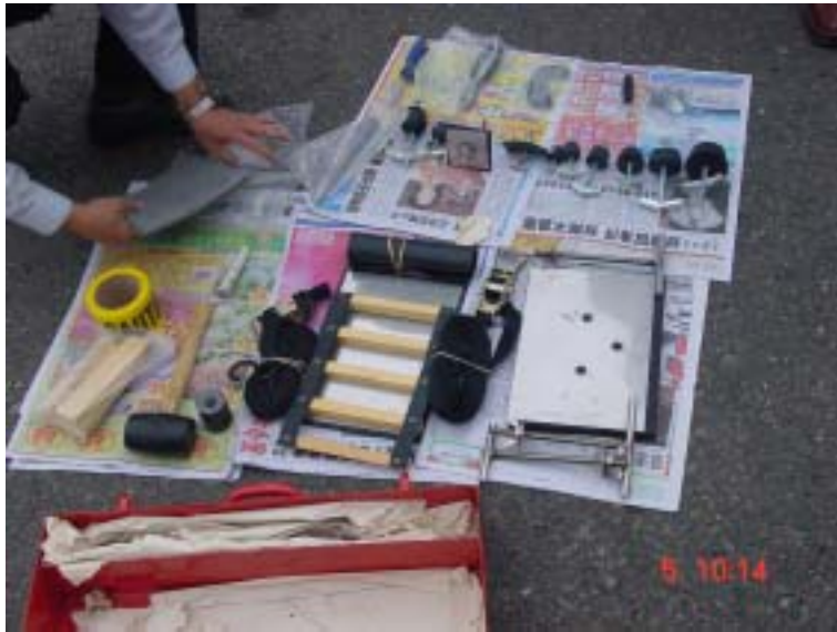
圖3.4.12 低壓容器破洞堵漏工具組裝備圖
