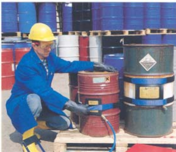
圖3.4.5 1.5BAR 破桶充氣洩漏密封片使用圖(53加侖鐵桶)
