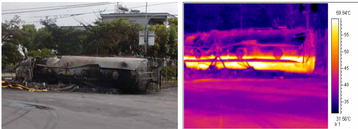
圖 3.1.2 紅外線熱像測溫儀測得翻覆油罐車槽車內剩餘液體量
