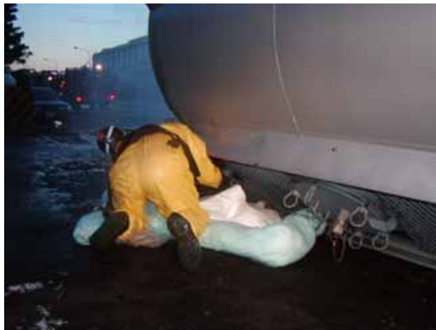
圖 4.3.8 中心提供吸液棉進行圍堵作業
