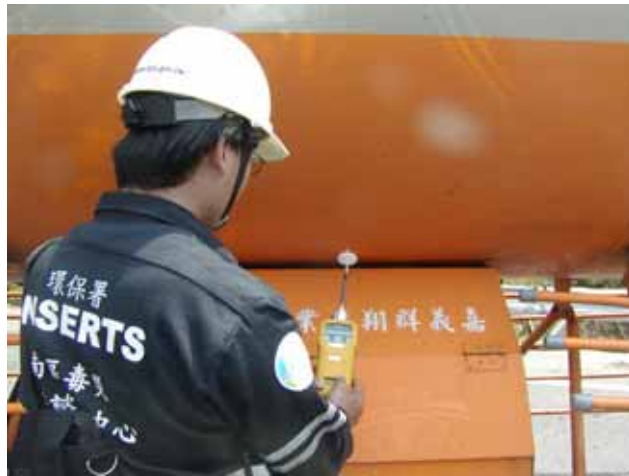
圖 4.3.11 中心應變人員以光離子偵測器偵測
