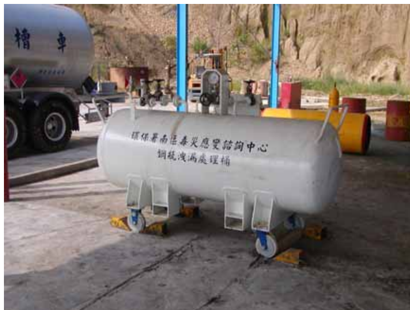
圖 2.2.5 實作訓練場場址_高壓氣體鋼瓶洩漏模擬情境
