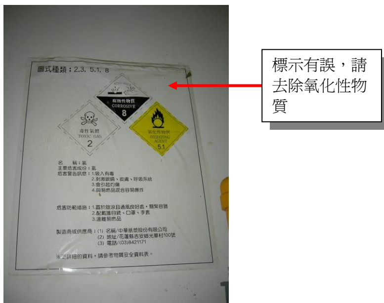
圖 6.5 氯氣危害標示
