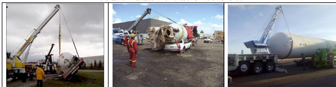
圖 4.5 美國陸路槽車使用吊車（吊帶）進行扶正與吊離作業
