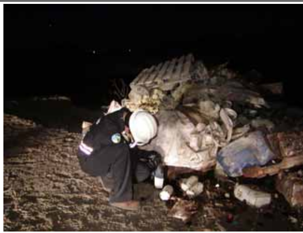
照片 6・應變人員進行 XRF 偵測
