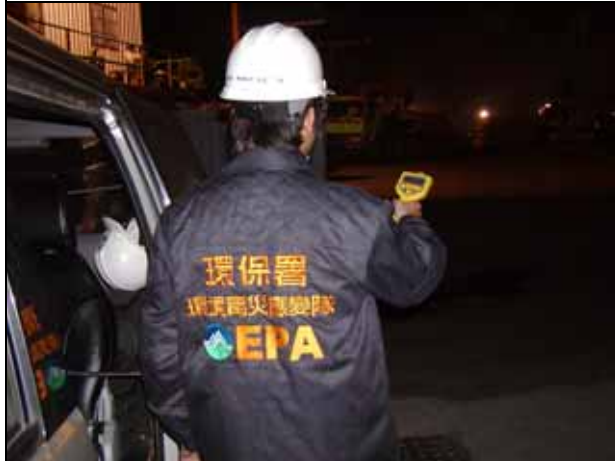
照片 3、應變人員利用 PID 進行空氣採樣
