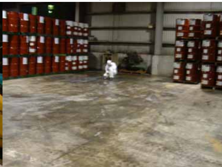
照片6・應變人員於洩漏處清理完畢後以PID進行濃度監測
