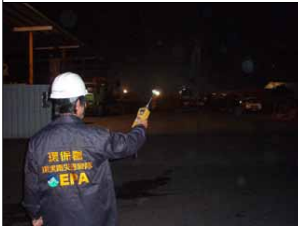
照片 3、應變人員利用 PID 進行空氣採樣
