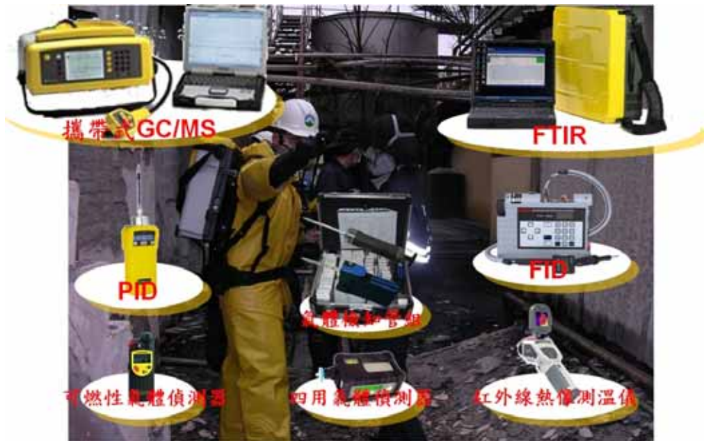
圖 3.1.12、執行災害現場毒化物濃度偵測作業情形
