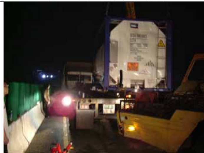
照片 7・吊車進行槽體吊離作業
