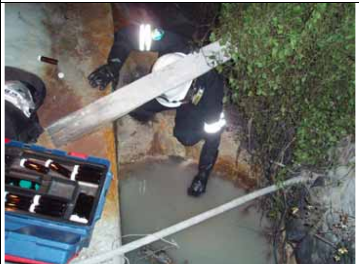
照片 6・利用 pH 試紙檢測廠內水溝的 pH 值(pH=11)
