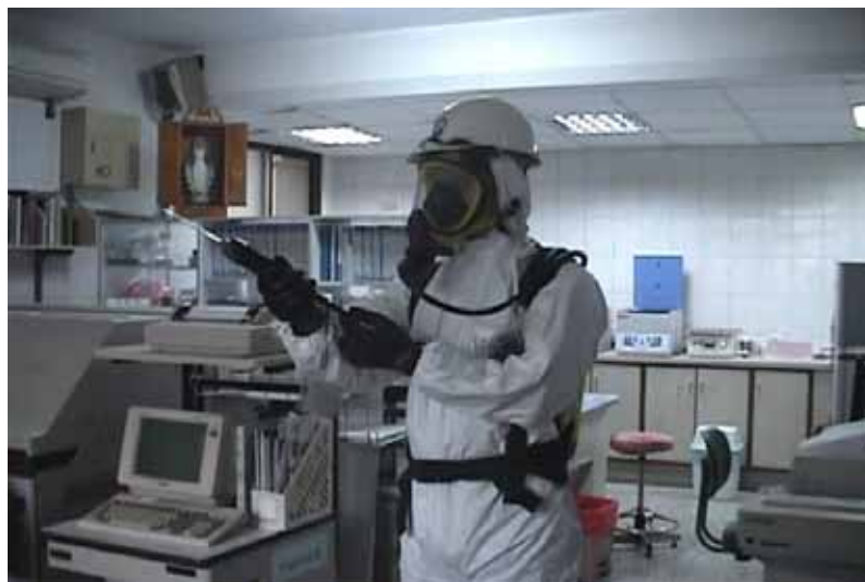
圖 3.1.37 毒災應變隊員於檢驗室利用甲醛檢知管進行偵測
