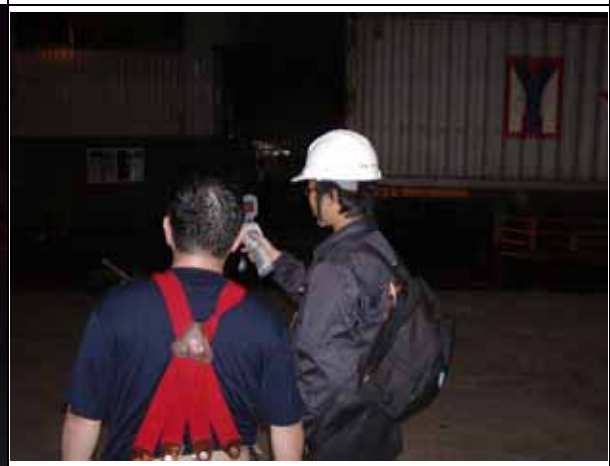
照片 4、應變人員與消防人員利用紅外線熱影像儀瞭解廠房內溫度
