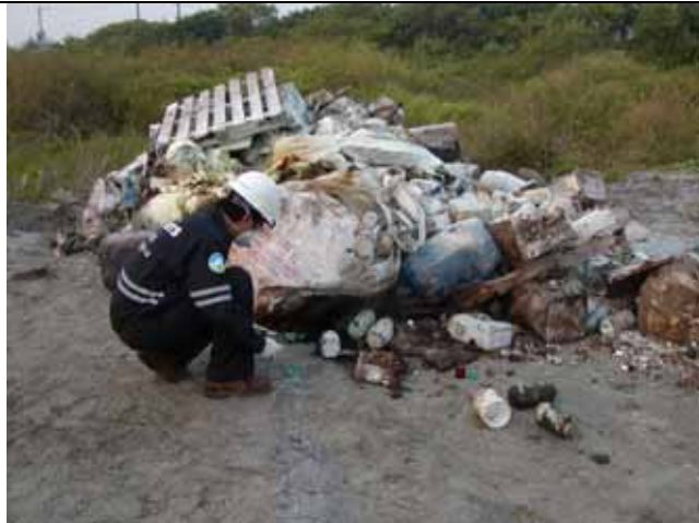
照片 6・應變人員進行 XRF 偵測
