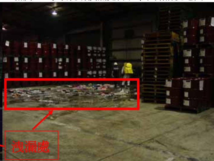
照片4・洩漏TDI筒子裝入回收筒進行稱重
