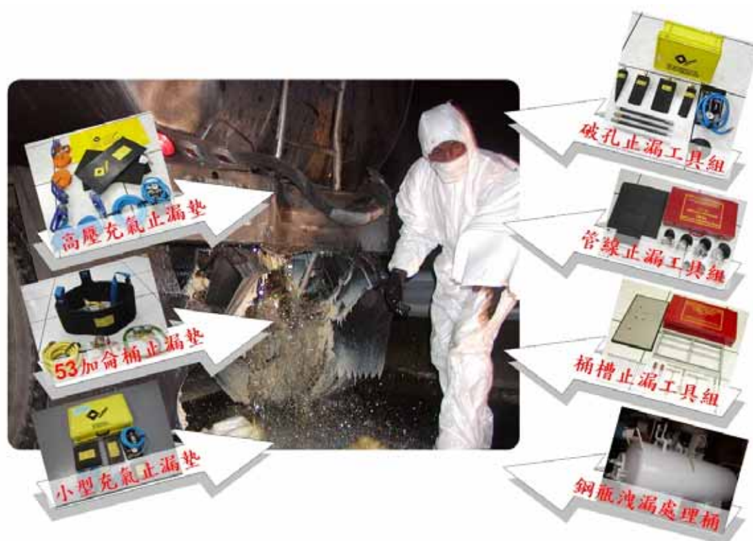
圖 3.1.13、模擬儲存容器毒化物外洩止漏情形
