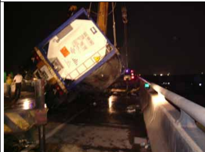
照片 5・吊車進行槽車扶正作業
