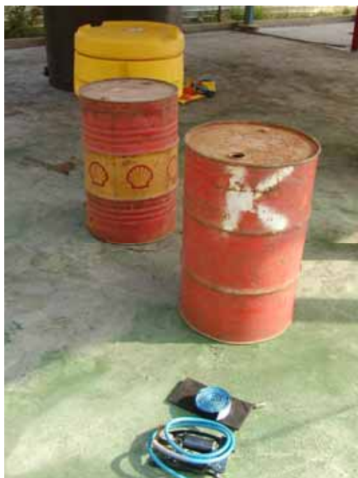
圖 3.1.48、毒災應變實作訓練場_53 加侖桶洩漏控制
