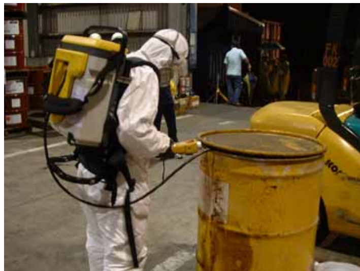
照片5・應變人員於回收筒進行GC-MS濃度監測
