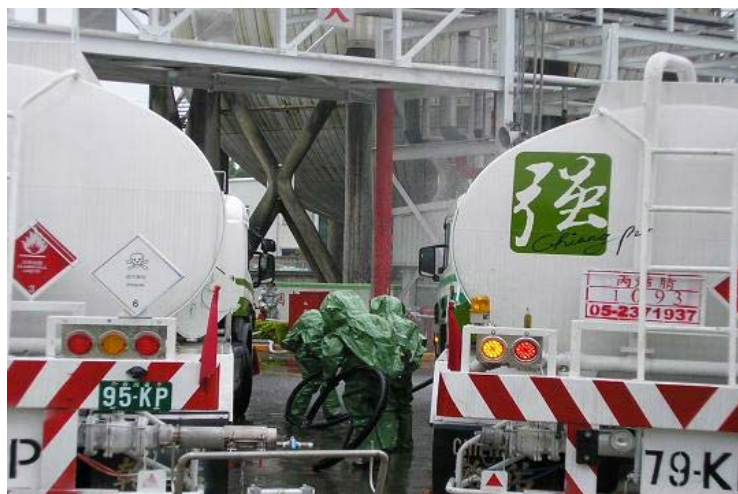
圖 4.4 化學槽車移槽處理情形
