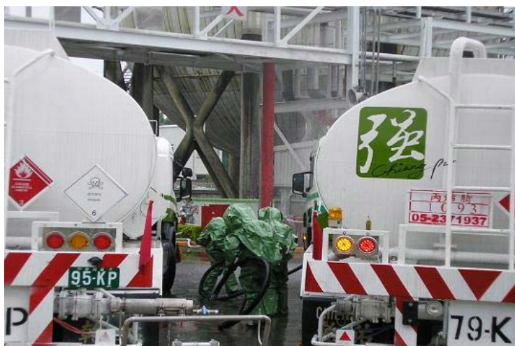
圖 5.4 化學槽車移槽處理情形
