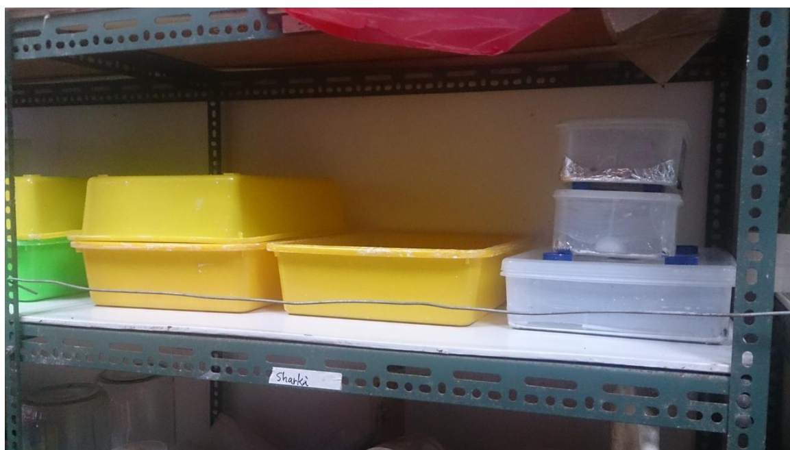
圖一：實驗架上加裝鐵絲，防止養蟲設備傾倒。
