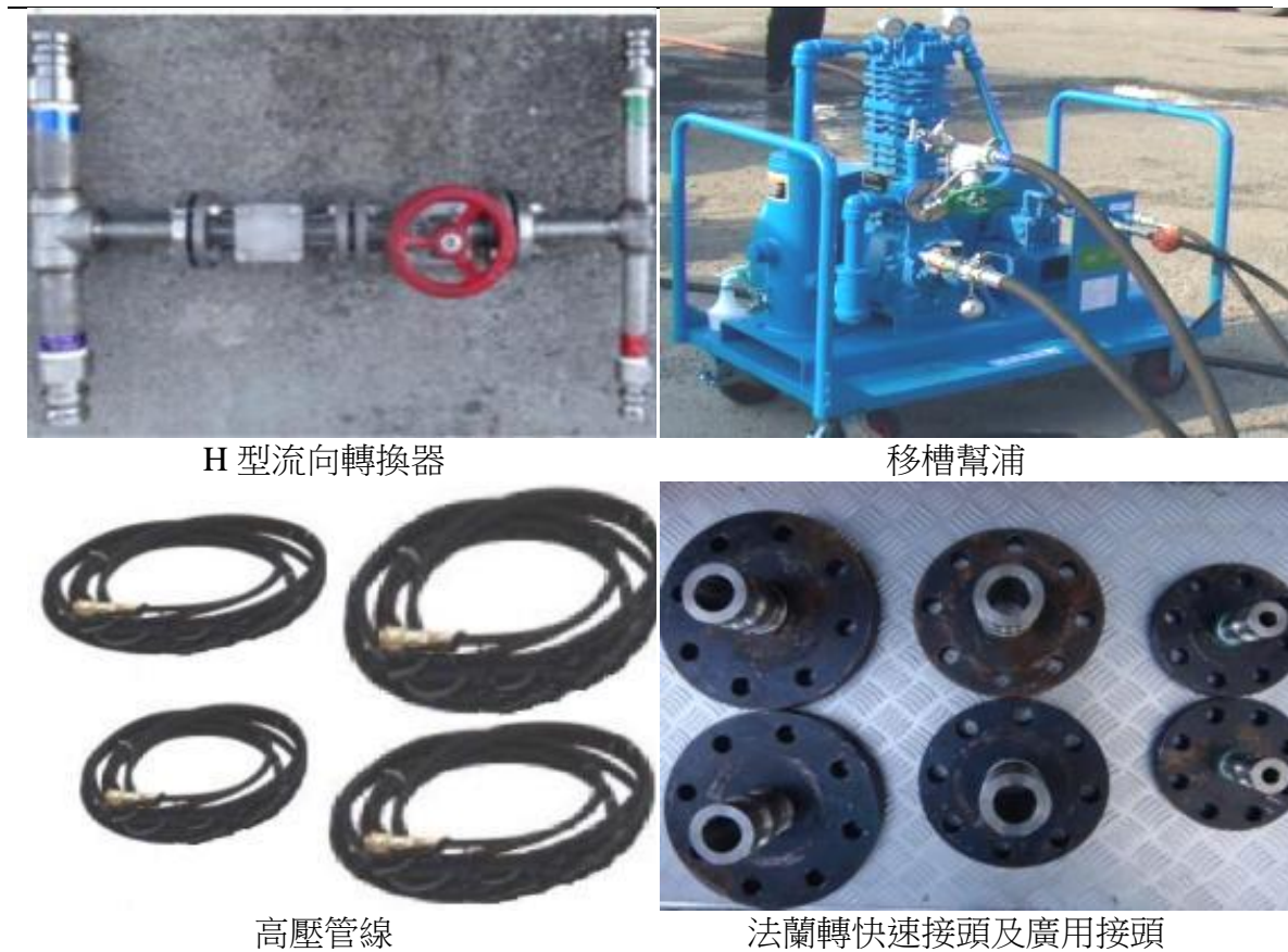
圖 4.1-10 高壓槽車移槽處理所需設備
