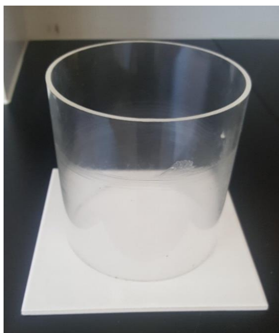
圖 2. 圓形壓克力昆蟲測試裝置及磁磚
