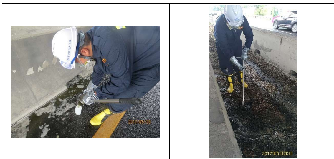
圖 4.3.1 事故現場污染土質及水體採樣作業情形
