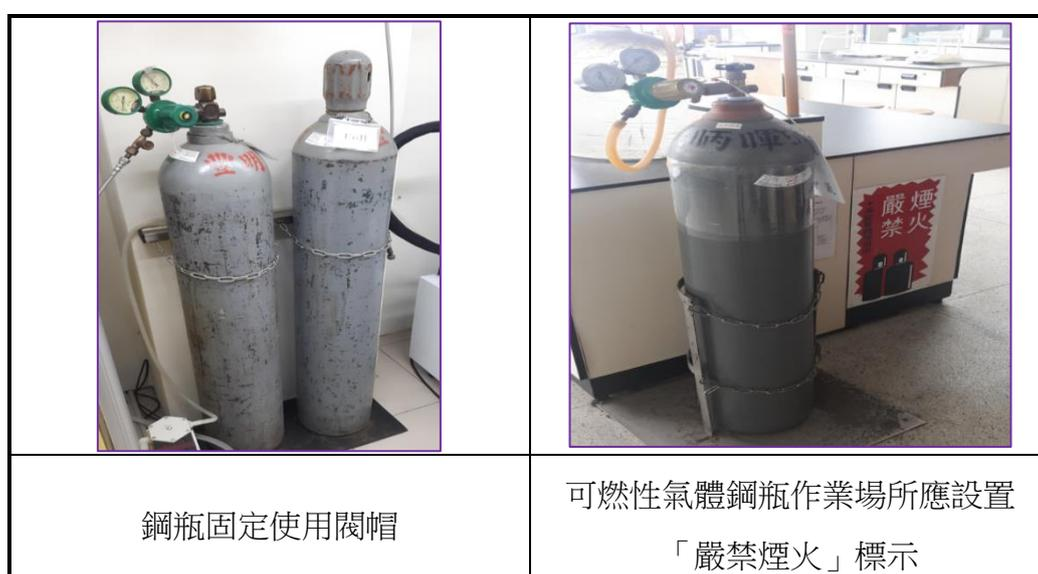
圖 3.1-7 氣體鋼瓶貯放情形正反案例圖
