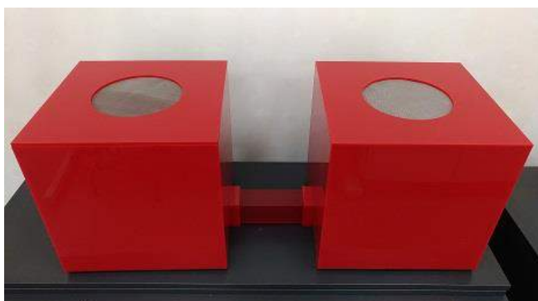
圖 9. 箱型壓克力昆蟲測試裝置 (蟑螂)
