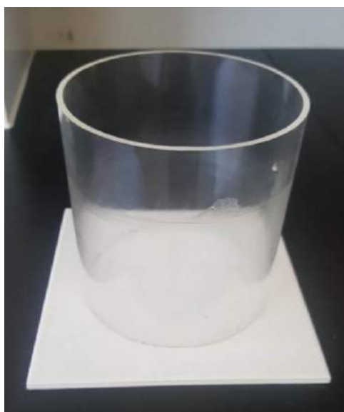
圖 2. 圓形壓克力昆蟲測試裝置及磁磚
