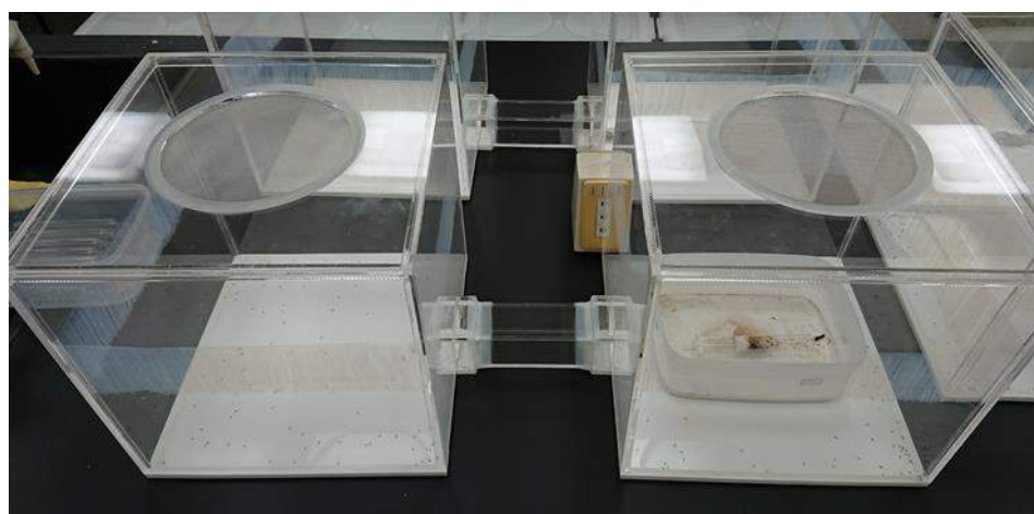
圖 11. 箱型壓克力昆蟲測試裝置 (螞蟻)
