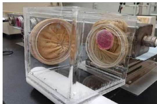
圖 3-2. 人工餵血膜裝置測試
