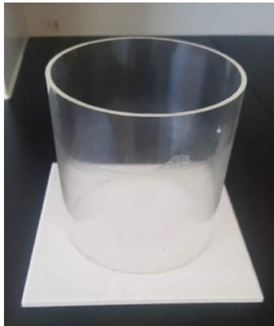
圖 2. 圓形壓克力昆蟲測試裝置及磁磚
