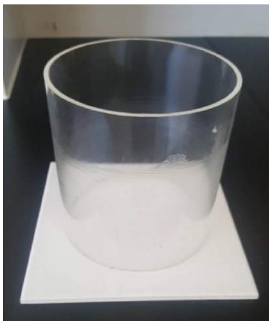
圖 2. 圓形壓克力昆蟲測試裝置及磁磚
