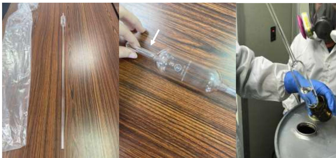
圖 5.1-3、廠家自行燒製之液體採樣管
