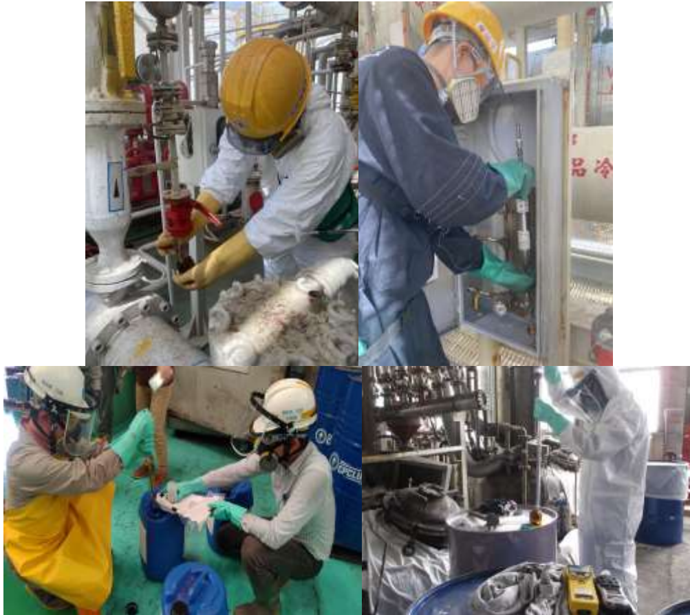
(左上)控制閥採樣、(右上)高壓鋼瓶採樣、(左下)移液管採樣、(右下)混合液採樣管採樣
