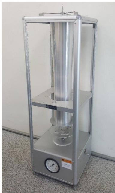
圖 12. 波特噴霧塔 (Potter Spray Tower)
