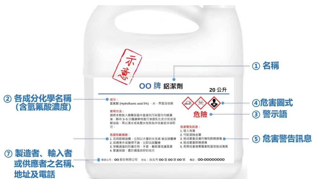
圖 2.3-2 未達管制濃度氫氟酸製成品應標示內容示意圖
