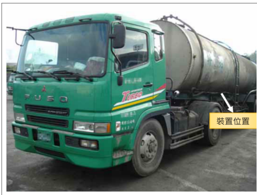
圖 3.2-6 GPS 裝置於尾車位置示意圖
