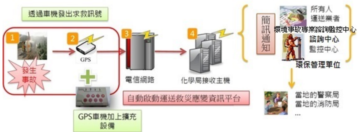
圖 3.3-12 緊急聯繫通報機制流程圖
